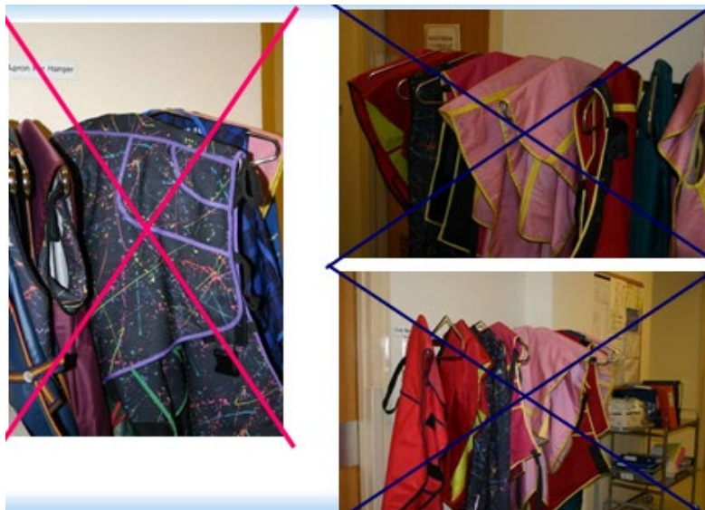
Figura 9.23. Ejemplos de mal almacenamiento de delantales plomados.
